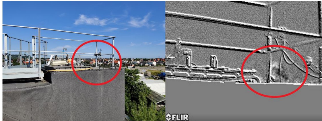
Figur 1: Lækage #1, fra vandlås på rådnetank. Lækagen kan ses ved den mørke sky, som er markeret på billedet til højre. Udklip fra MOV_0937.
